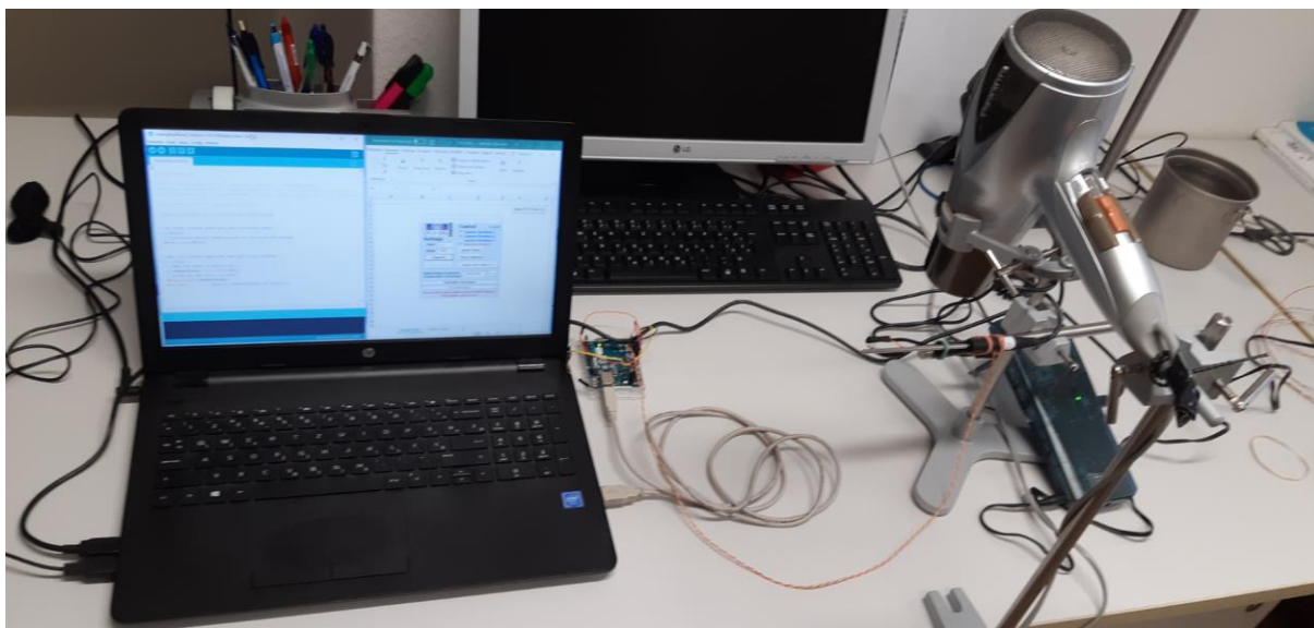
Slika 11: Postavitev za umerjanje in za preizkušanje merjenja temperature zraka – primerjava z rezultati merilnika Vernier
