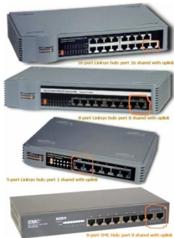
Slika 10 HUBi s označenimi povezovalnimi vmesniki. Več ponavljalnikov lahko med seboj povezujemo.
